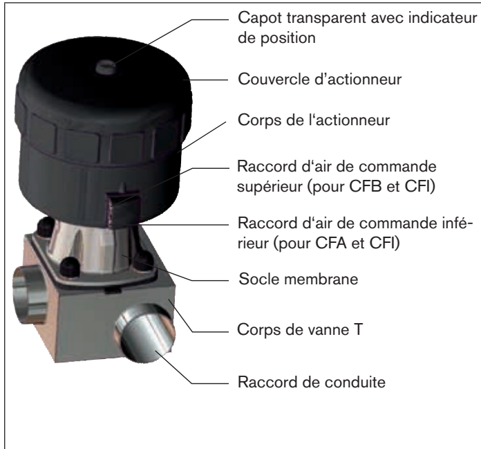
Fig. 9 : Structure et description Type 2032
