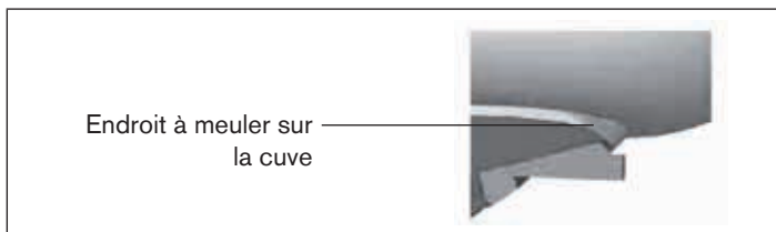
Fig. 9 : Endroit à meuler sur la cuve
