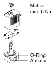
Die Spule kann um 4 x 90° verdreht werden (bei Blockmontage nur 2 x 180°).
