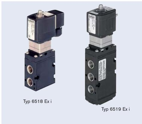
Die eigensicheren Ventile Typ 6518 Ex i und 6519 Ex i bestehen aus einer eigensicheren Vorsteuerung und einem pneumatischen Verstärker. Die membrangesteuerten Ventilsitze arbeiten extrem reibungsarm und ermöglichen das sichere Rückschalten der Ventile auch nach langen Stillstandzeiten.
