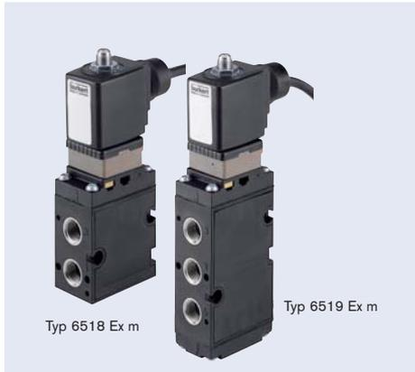
Die Zulassung Ex m wird durch die Bestückung des Ventiles mit einer entsprechenden übergesteckten Spule erreicht. Der Kabelanschluss und das Kabel sind unlösbar mit der Spule vergossen. Die Ventile sind einzeln oder auf Blöcken einsetzbar.
