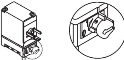
Bei Automatikbetrieb muß die Handnotbetätigung immer in Grundstellung („0“) gebracht werden.
