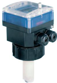
Das Durchflussmessgerät kombiniert einen Flügelrad Durchflusssensor und ein Elektronikmodul mit Display in einem IP65 Gehäuse. Der elektrische Anschluss des Transmitters erfolgt über einem Kabelstecker oder zwei Kabelverschraubungen.
