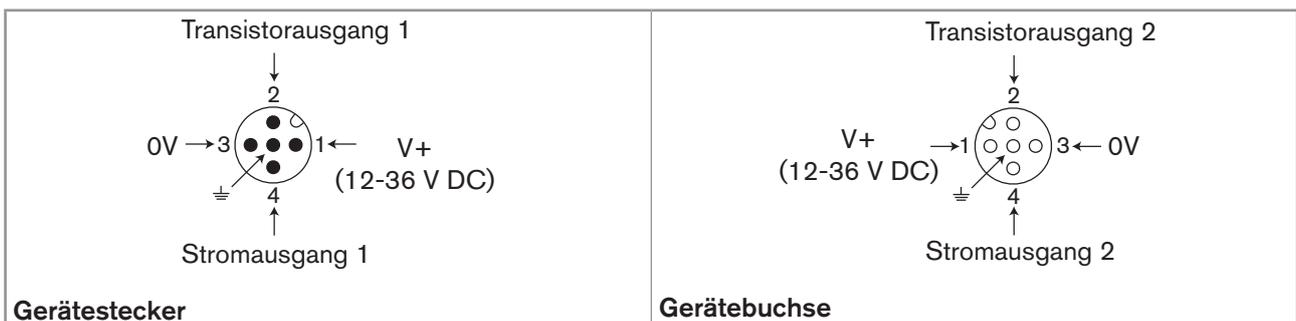
Bild 22: Klemmenbelegung des M12-Gerätesteckers und der M12-Gerätebuchse
