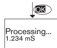
Der Transmitter legt die Kompensationskurve in 10 Punkte fest und, wenn der Hold Modus deaktiviert ist (siehe Kap. 9.12.1), wird abwechselnd die gemessene Leitfähigkeit der Lösung und die gemessene Temperatur der Lösung angezeigt.
