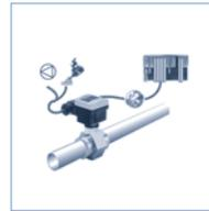
Überwachung von min./max. Temperaturwerten in einem laufenden Prozess (Kompakte INLINE-Regelung)
