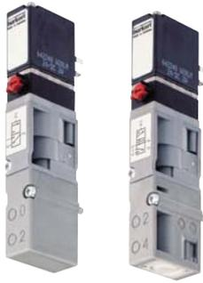
Die Ventile vom Typ 6526 und 6527 bestehen aus einem Vorsteuer-Wippenmagnetventil vom Typ 6106 und einem Pneumatiksziventil. Das Wirkprinzip erlaubt das Schalten hoher Drücke bei geringer Leistungsaufnahme und mit kurzen Schaltzeiten. Die Vorsteuerventile sind serienmäßig mit einer Handbetätigung ausgestattet.
